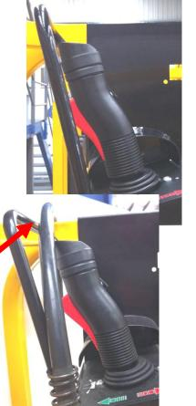
WELD HOSE BLOCKED BY GUARD BAR TO RHS
