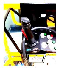
THE JOYSTICK IS PUSHED BACK AS HOSE IS FORCED AROUND IT. THIS LOWERS SCISSOR = AWAY FROM CRUSH HAZARD
